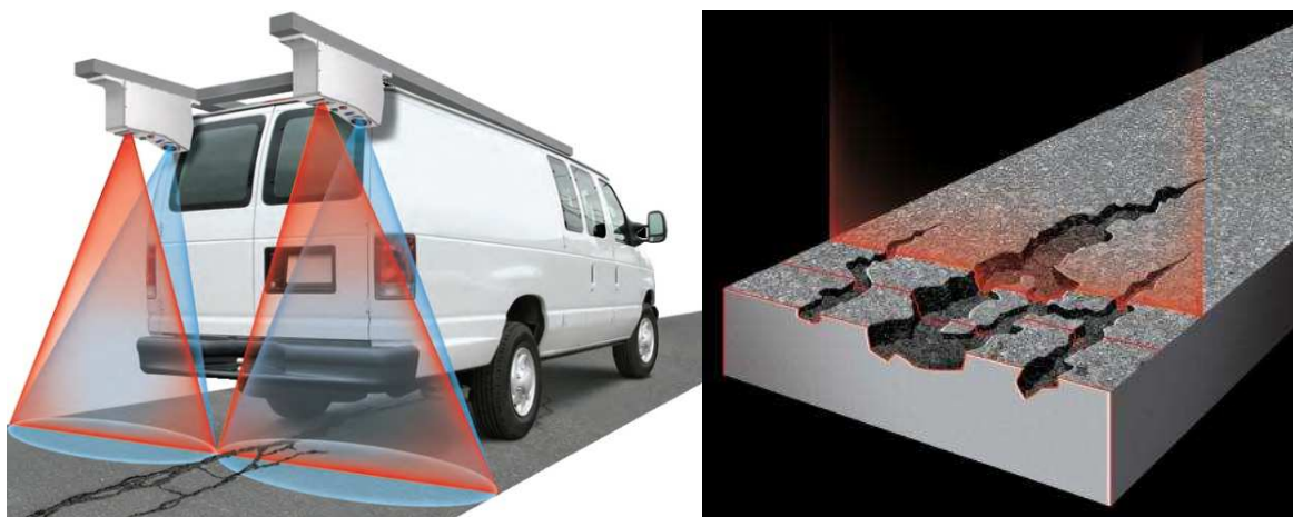
Rysunek 16. Zestaw pomiarowy wykorzystywany w automatycznej ocenie nawierzchni oraz widok ogólnej zasady działania systemu
